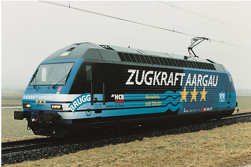
Bild 12.02 Dächer und Seitenschürzen für Lok 2000 hergestellt in RIM / RTM Verfahrenstechnik
